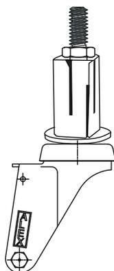
**Fijación con expansivo de plástico:**
