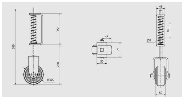
**NOTA:** Ruedas especialmente diseñadas para puertas de gran tamaño. No están diseñadas para soportar todo el peso de la puerta (50/75 kg.)
