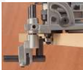
Freno del rodamiento de la fresa para evitar marcas sobre el panel.
