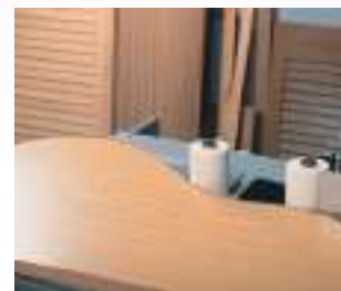
Aplacado de piezas curvas.
