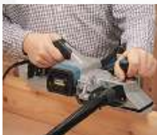
Equipado con toma para la conexión a un aspirador.
