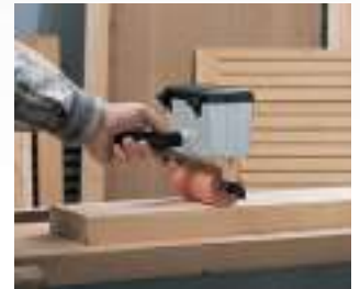
Encolado con colas vinílicas (blancas).
