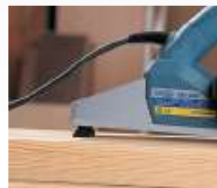
Zapata de apoyo que evita el riesgo de dañar las superficies al dejar el cepillo en reposo.
