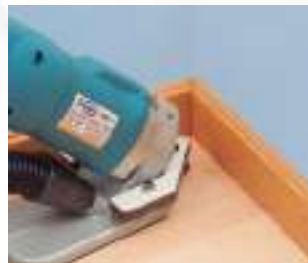
Permite enrasar las esquinas a las que no llega la lijadora tradicional de parquet.
