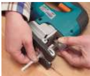
Cambio de hoja de sierra fácil y rápido con una sola mano.
