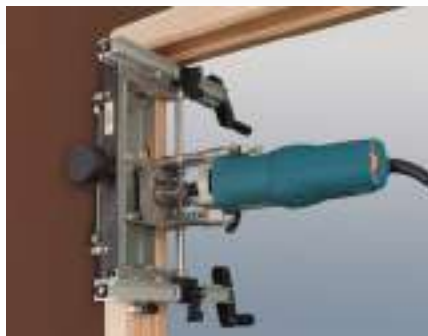
Realización del encaje superior en el marco.
