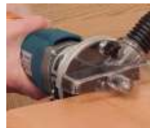
Cabezal redondo V3 incluido en el equipo. Muy práctico para perfilar con apoyo sobre el canto e imprescindible para los trabajos que así lo requieren.
