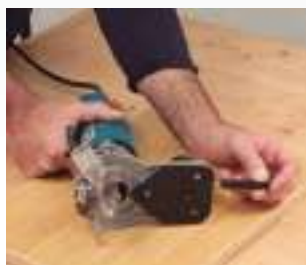
Dispositivo de guiado para el perfilado de esquinas alojado en la base cuando no se usa. Su colocación es muy rápida y sencilla.
