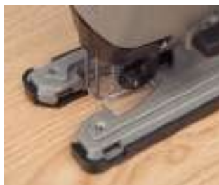
Guía de corte anti-astillas.
