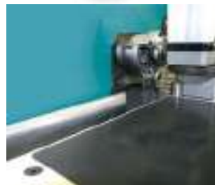
Con escuadra de registro para un rápido y fácil posicionamiento de la pieza a fresar.
