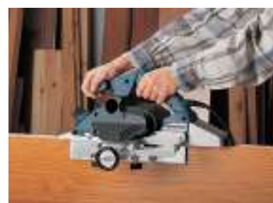
Escuadra micrométrica que permite realizar cepillados inclinados a distintos grados.
