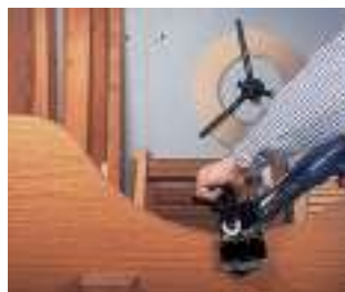
Aplacado de piezas circulares o con formas.
