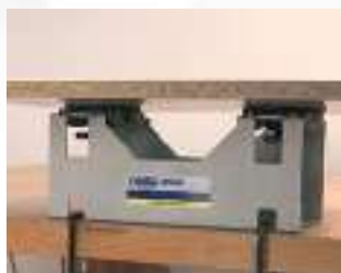
Firme fijación de las piezas. Sujeción al banco de trabajo mediante los sargentos incluidos.
