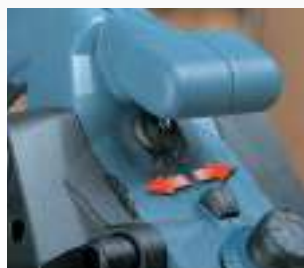
Palanca para la selección del lado de salida de viruta. Toma para aspiración externa a ambos lados.
