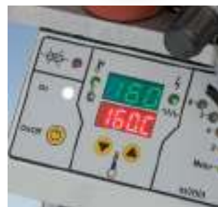
Regulación de la temperatura (120 a 200°C) controlada por microprocesador para una mayor exactitud en la medición. Sistema de elevación de la temperatura por impulsos. Protege las resistencias y aumenta su durabilidad.
