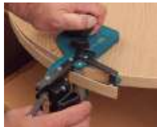
Retestado del sobrante en paneles circulares.
