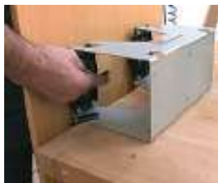
Mediante el uso de dos soportes es posible fijar tableros de grandes dimensiones.
