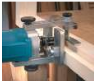
Realización de galce con la fresa opcional ref. 1240046 (deben usarse los esquís ref. 1250041 ó 1850042)
