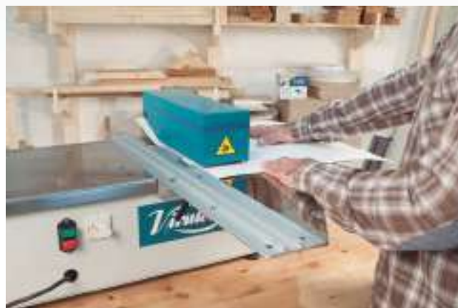
Destaca especialmente la posibilidad de trabajar con láminas de cualquier tamaño, ofreciendo su mesa de trabajo el apoyo suficiente para obtener buenos cortes.
