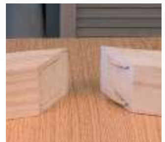
Ensamblajes de extrema solidez con pastillas grandes del No. 6.
